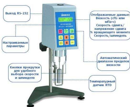
Рисунок 9 - Ротационный вискозиметр «Brookfield RVDV-II+».
